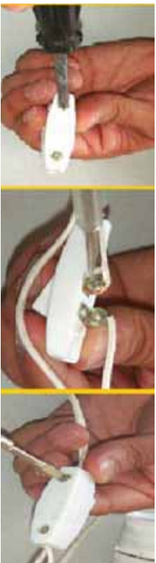
شکل (۲-۲۴) د سيار څراغ د سیم په امتداد کې د سوچ د نصبولو مرحلې
